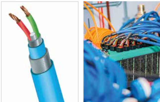
Obr. 2 Tienenie chráni krútený pár pred vonkajšími elektromagnetickými vplyvmi a zabráňuje vyžarovaniu rušenia samotným káblom. Modrý vonkajší plášť označuje, že kábel je bezpečný na použitie v potenciálne výbušnom prostredí.
