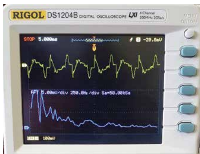
Obr. 5 Priebeh prúdu v neutrálnom vodiči (hore) s jeho FFT (dole) získaný pomocou digitálneho osciloskopu RIGOL DS1204B
