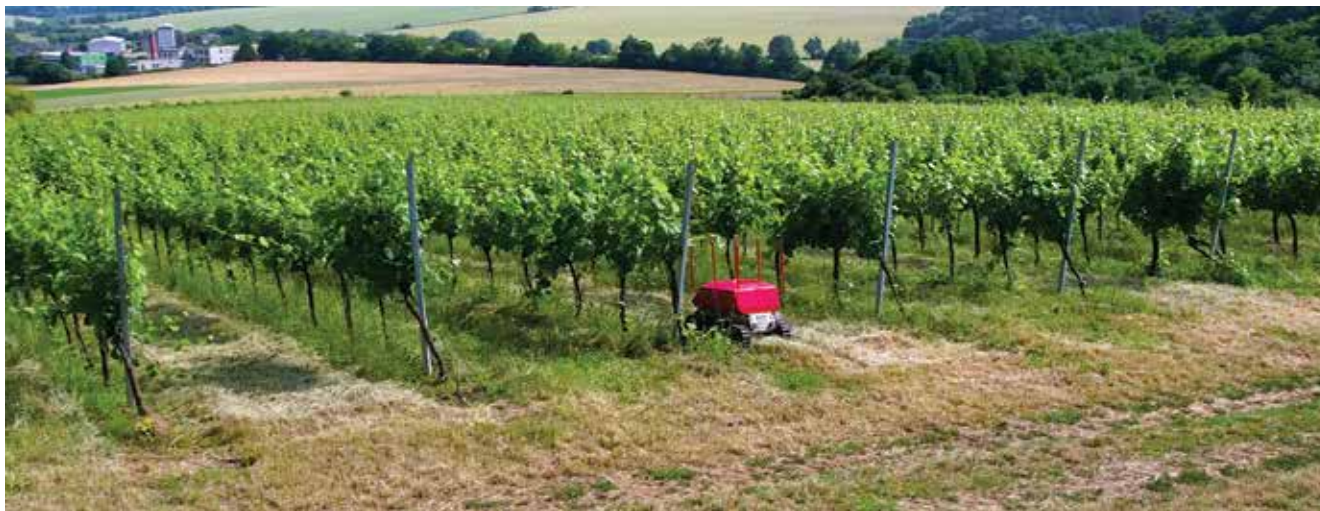
Obr. 4 Mobilná robotická platforma pri testovaní navigácie medzi riadkami vo vinohrade
